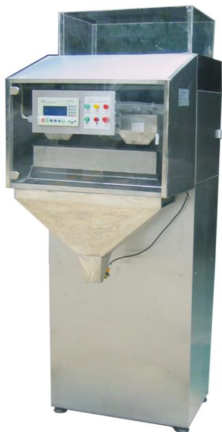
Автоматический электронный весовой дозатор серии EWM главным образом состоит из загрузочного бункера, вибрационного податчика, дозирующего весового устройства, механизма сбросы дозы и т.д.
