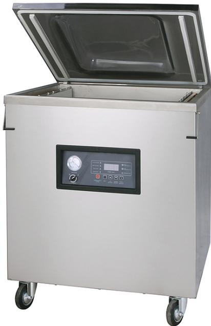
Автоматическая настольная вакуум-упаковочная машина EV-20 — это компактное оборудование для небольших производств и предприятий розничной торговли. Однокамерная модель используется в пищевой, фармацевтической, химической и электронной промышленности.
