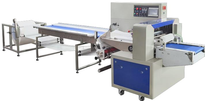
Горизонтальная упаковочная машина DXDZ-600XD (3 servo, лент. 250 мм, рег.форм., min bag L 180, Н 120, трансп.попереч.запайки) представляет серию оборудования для упаковки различных пищевых и непищевых продуктов в трехшовный пакет «подушка» (или flow-pack). В данной комплектации имеется датчик для отслеживания длины продукта, таким образом машина работает в двух режимах.
