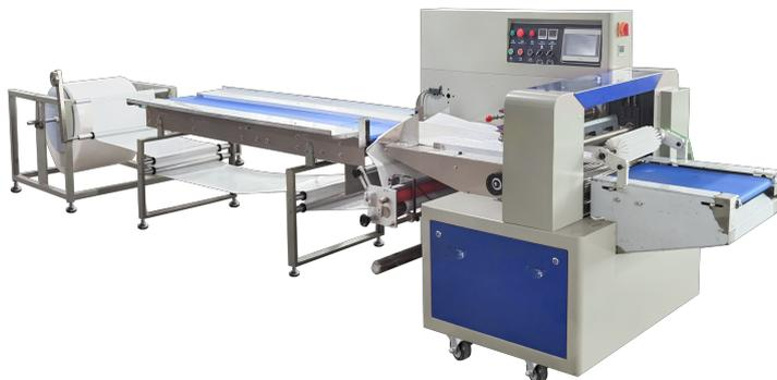
Автоматическая горизонтальная упаковочная машина DXDZ-600XD (bubble, 3 servo, лент. 250 мм, рег. форм., min bag L 250, H 120, трансп.попереч.запайки) представляет серию оборудования для упаковки различных пищевых и непищевых продуктов в трехшовный пакет «подушка» (или flow-pack). В данной комплектации имеется датчик для отслеживания длины продукта, таким образом машина работает в двух режимах.
