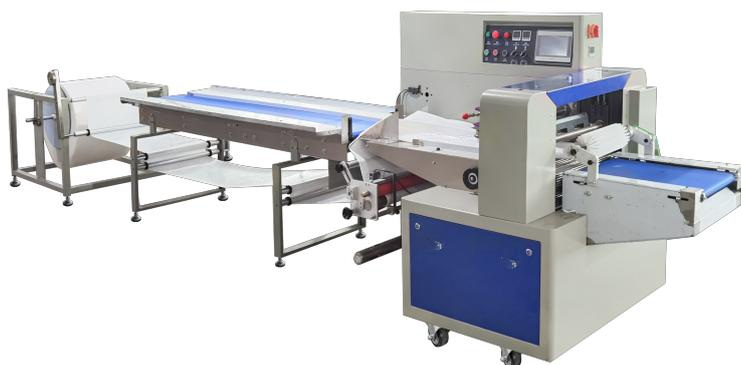
Автоматическая горизонтальная упаковочная машина DXDZ-350XD (bubble, 3 servo, лент.150 мм, рег.форм., min bag L 120, H 50, трансп.попереч.запайки) с нижней подачей от компании Hualian – одна из самых популярных моделей в ассортименте.
