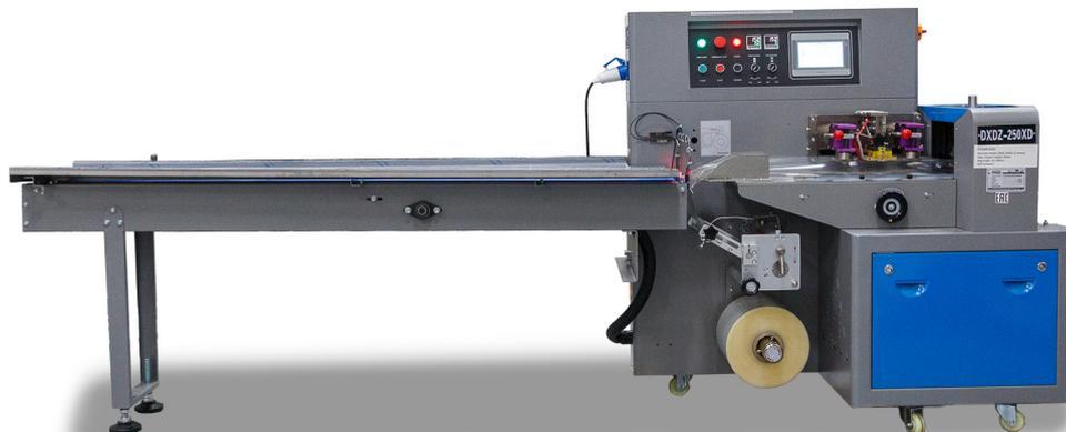
Горизонтальная упаковочная машина DXDZ-250XD (3 servo, лент. 150 мм, рег.форм., min bag L 65, H 40, 2-х позиц.нож) представляет серию оборудования для упаковки различных пищевых и непищевых продуктов в трехшовный пакет «подушка» (или flow-rack). В данной комплектации имеется датчик для отслеживания длины продукта, таким образом машина работает в двух режимах.
