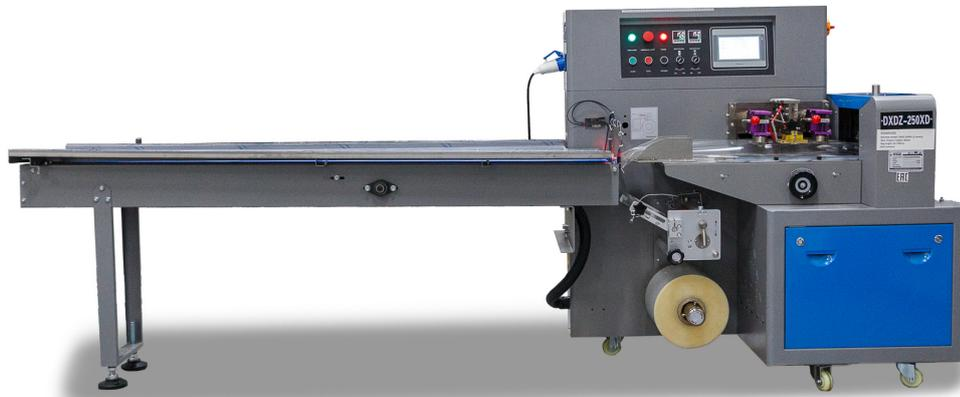
Горизонтальная упаковочная машина DXDZ-250XD NEW (H-40мм, bag L 65-190mm, S 200mm, регулируемый формователь, вставки в транспортере) представляет серию оборудования для упаковки различных пищевых и непищевых продуктов в трехшовный пакет «подушка» (или flow-pack). Особенностью данной модели является нижняя подача пленки, что дает ее оптимальным вариантом для упаковки предметов нестабильной формы: свежей зелени, салатов, салфеток, пластиковой одноразовая посуда, перчаток и т.д.
