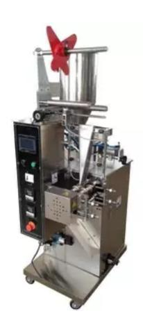
Автоматическая вертикальная фасовочно-упаковочная машина серии DXDG применяет систему поршневого дозирования и электронную регулировку длины пакета при помощи PLC-контроллера. Регулировка дозы осуществляется ходом поршня. В качестве упаковочного материала применяются термосвариваемые комбинированные материалы, например бумага/ПЕ, целлофан/ПЕ, алюминиевая фольга/ПЕ, БОПП/ПЕ, Нейлон/ПЕ и т.д.
