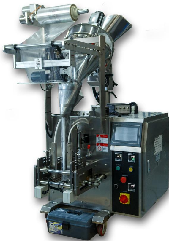
Автоматическая вертикальная фасовочно-упаковочная машина для трудно-сыпучих продуктов и порошков серии DXDF применяет высокоточную систему шнекового дозирования. В качестве упаковочного материала применяются термосвариваемые комбинированные материалы, например бумага/ПЕ, целлофан/ПЕ, алюминиевая фольга/ПЕ, БОПП/ПЕ, Нейлон/ПЕ и т.д.
