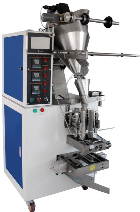
Автоматическая вертикальная фасовочно-упаковочная машина для трудно-сыпучих продуктов и порошков серии DXDF применяет высокоточную систему шнекового дозирования. В качестве упаковочного материала применяются термосвариваемые комбинированные материалы, например бумага/ПЕ, целлофан/ПЕ, алюминиевая фольга/ПЕ, БОПП/ПЕ, Нейлон/ПЕ и т.д.
