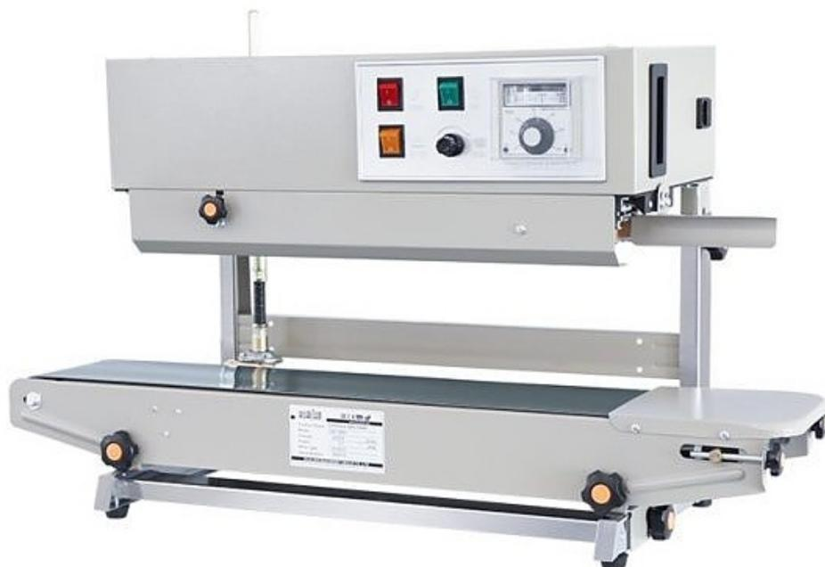
DBF-900V LOW COST – это версия роликового конвейерного запайщика DBF-900 в вертикальном исполнении. Запайщик предназначен для вертикальной запайки пакетов из различных термосвариваемых материалов, включая многослойные и кашированные. Возможна работа с пакетами типа «дой-пак».
