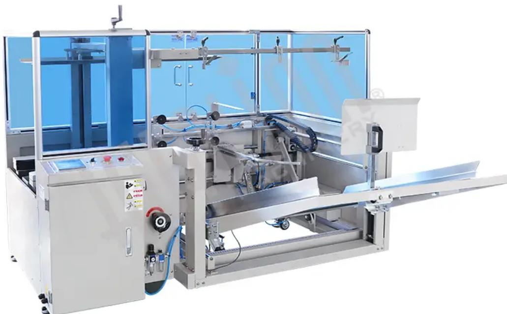
СХJ-4540D (крашенный корпус) – это автоматический сборщик коробов, который можно встраивать в действующие производственные линии.
