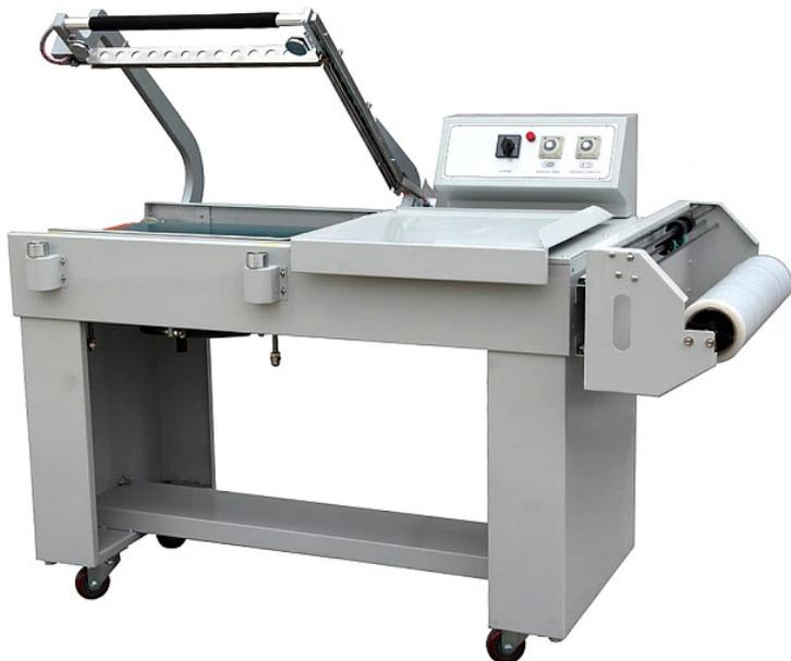
Упаковочная машина BSL-7560L представляет собой горизонтальное полуавтоматическое оборудование для L-образной запайки и обрезки упаковки. Устройство обеспечивает высокую эффективность упаковочных процессов благодаря автоматическому перемещению продукции в термоусадочный туннель с помощью конвейерной ленты.
