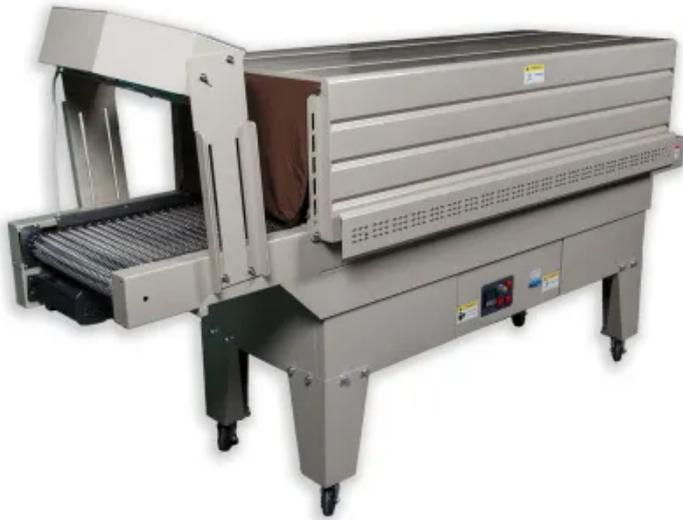
Термоусадочный тоннель BS-6535LA для PE пленки – кастомизированная обновленная версия предыдущей модели, поставляемая в комплекте с сетчатым конвейером.
